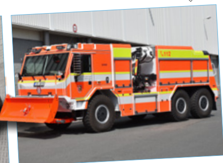
Berge- und Löschfahrzeug auf Tatra Force 6x6 des Fahrzeugherstellers Kobil
