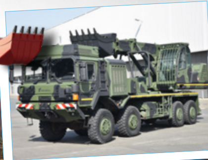
Rheinmetal HX 8x8 Excavator, hochmobiler Mehrzweckbagger auf MAN D 2676, 397 kW, 38 T
