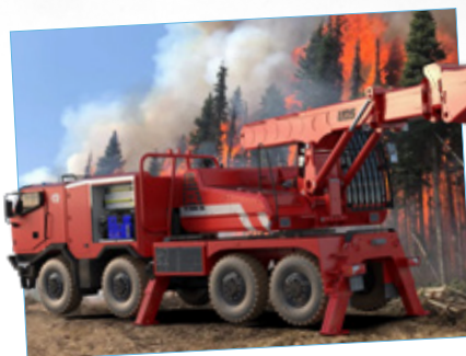
Rosenbauer Waldbrandbagger auf Tatra 8x8, 325 kW, Baggermotor extra 126 PS
