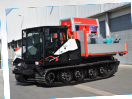
Power Bully 9C mit Stromaggregat, 9 Tonnen 173 kW
